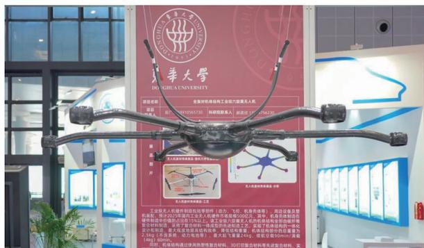
性，民航复材中心岳广全将“碳纤维复合材料一体成型制造工艺”应用到无人机机身壳体制造上，开发出全复材机体结构工业级六旋翼无人机，有效降低了机体重量，提升了续航里程。为了满足客户的个性化需求，该机体结构可模块式定制，使得这款无人机的市场竞争力进一步
